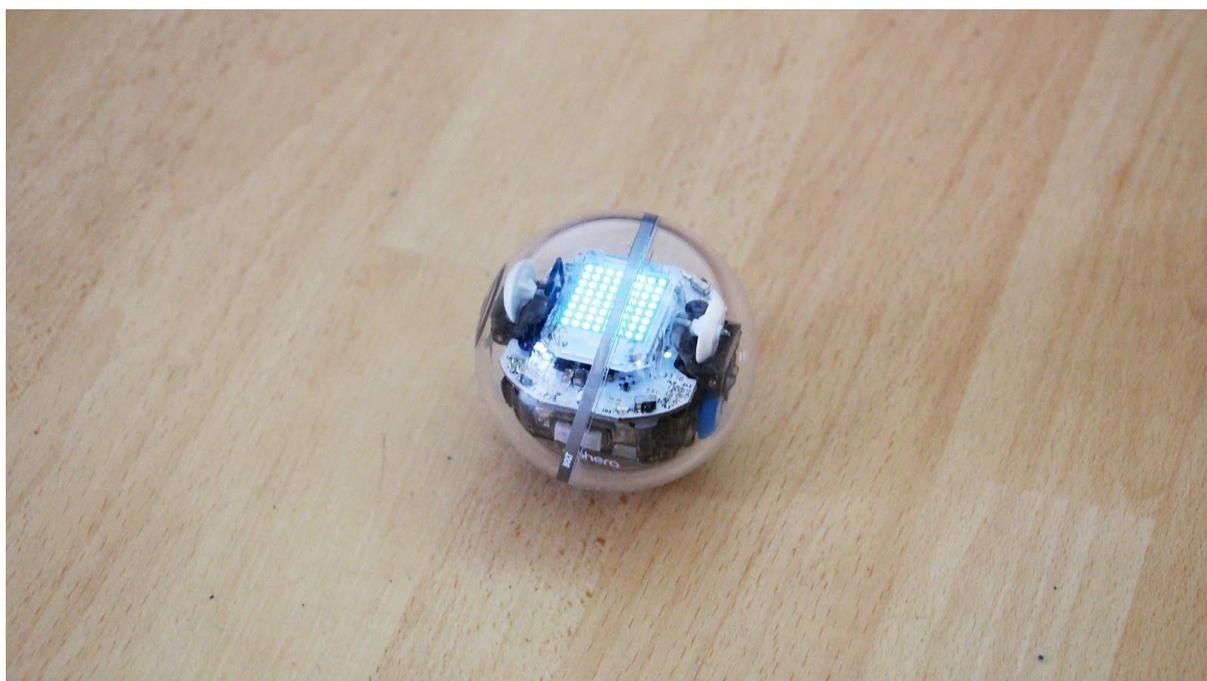
【床を動き回るロボット。進行方向やLEDの発光パターンをプログラミングできる】
