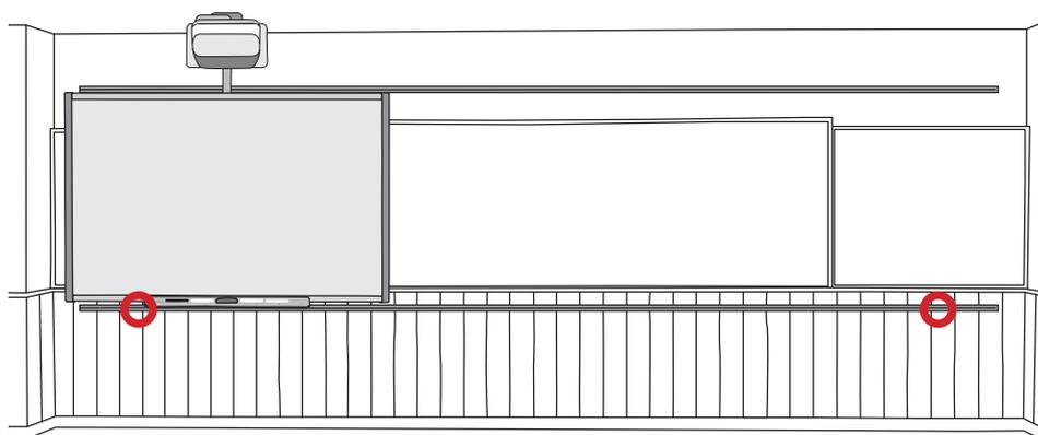
SMART Board と壁との間に、約 10cm の隙間をあけてストッパーを取り付けています。
