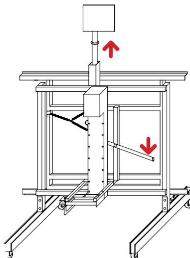
4. レバーを押し下げた状態で、固定ネジをしっかりと締め位置を固定します。
